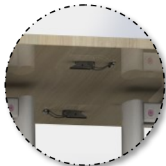
Grenouillères Système de solidarisation de 2 tables entre elles
